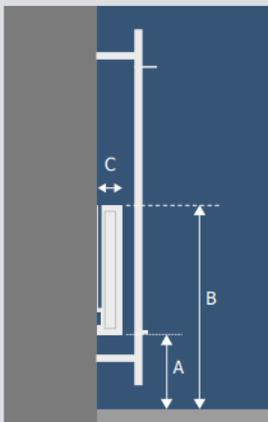
**MONTAJE DELANTE DE UN RADIADOR CON SEPARADOR DE MONTAJE EN PARED**
