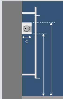
**MONTAJE DELANTE DE UN PANEL DE ALIMENTACIÓN CON SEPARADOR DE MONTAJE EN PARED**
